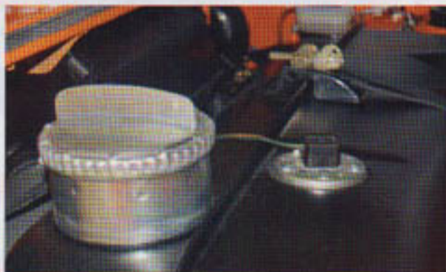
Schraubdeckel in Fahrtrichtung gedreht: Ein Ausschnitt im Frontdeckel macht die Schnelltankanlage vollständig
