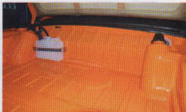
Karosseriedeckel aus Alu: Der Entfall stählerner Blindstopfen macht den Kofferraumboden 500 Gramm leichter
