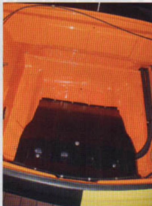
Ölkühlerschacht aus profiliertem Stahlblech: Heiße Abluft strömt nach unten durch den Kofferraumboden ins Freie
